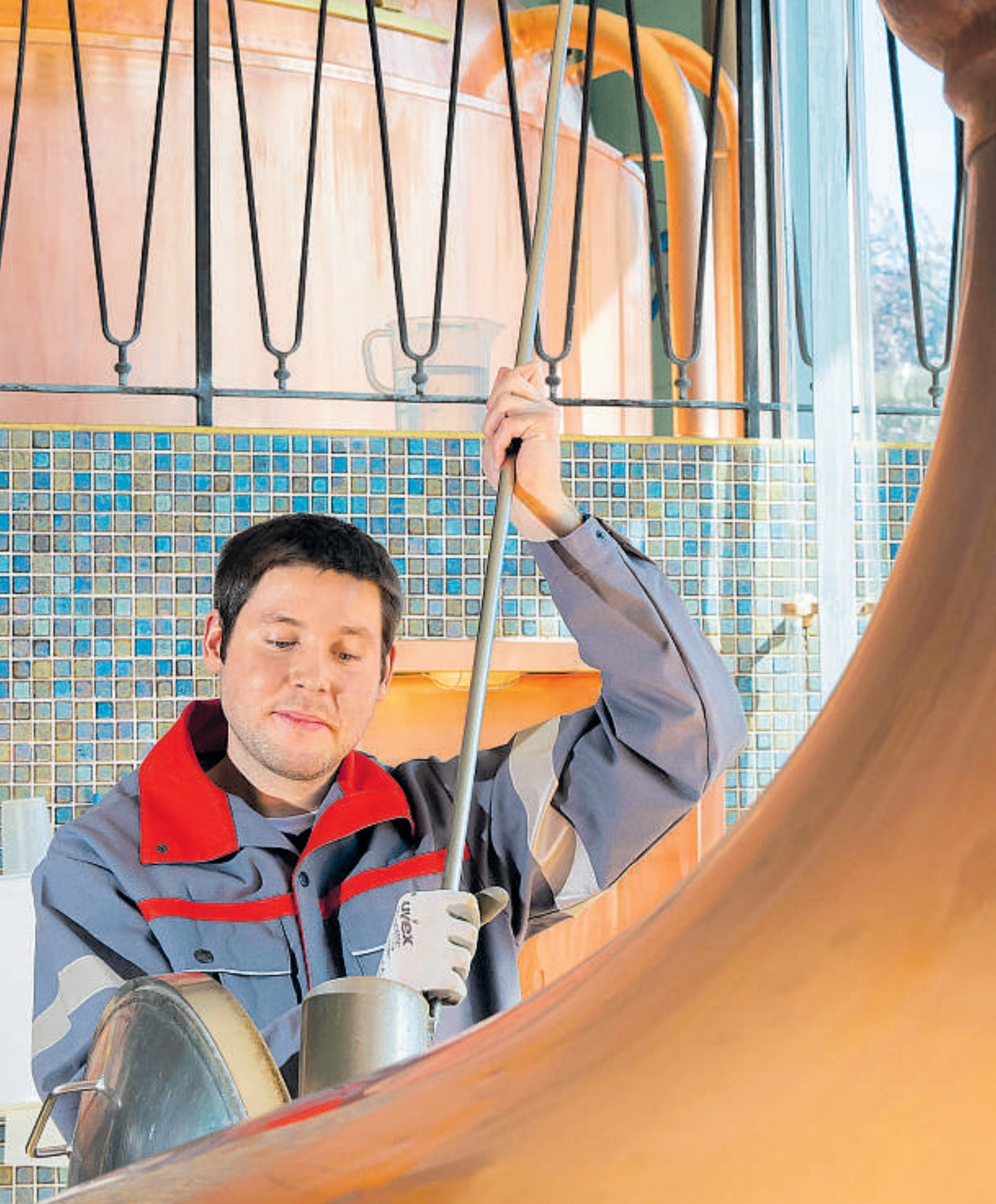
Bierbrauer Alain Schmid wirft ein Auge auf den Brauprozess im Kupferbottich: «Mit der Wärme von Heizedampf wird hier die Würze entkeimt.»
